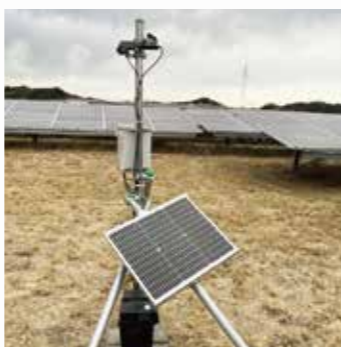
千葉県 メガソーラー発電所 バードソニック JK033
